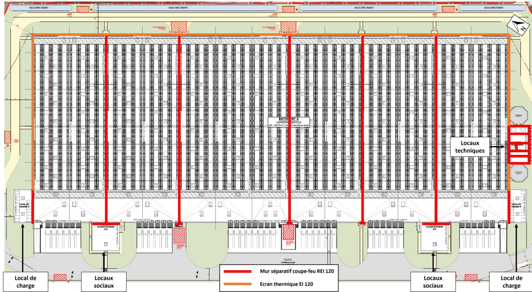
Figure 5 : Localisation des murs et parois du bâtiment
